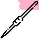
Pipeta volumétrica: utilizada para medir, com precisão, um volume fixo de líquido. Não pode ser aquecida.
